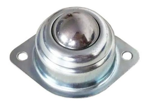
Realizzato interamente in metallo, questo ball caster è utilizzato come terzo punto d'appoggio nei robot, come cuscinetto in basi rotanti, ecc. È composto da una piccola sfera (diametro circa 16 mm) che ruota all'interno di una struttura, su alcune sfere più piccole che ne riducono l'attrito. Dimensioni (mm): 48x32x20, distanza fori di fissaggio: 39 mm, diametro fori di fissaggio: 4 mm.
