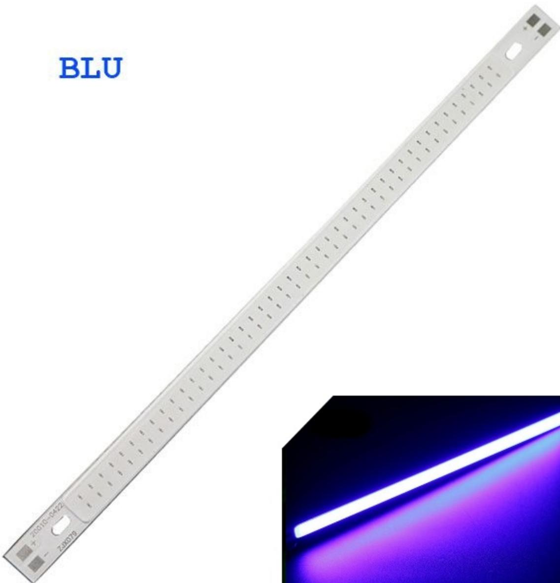
Barretta con LED COB blu ricoperti da gomma siliconica e realizzata su supporto in alluminio per una migliore dissipazione.
