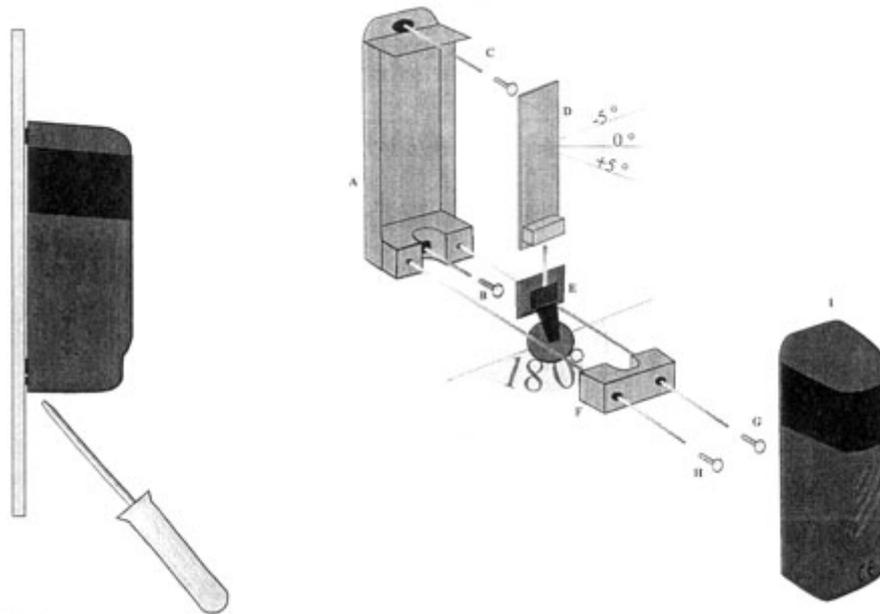
Per **aprire la fotocellula** fare leva con un cacciavite nella parte inferiore centrale del coperchio come indicato in figura.
