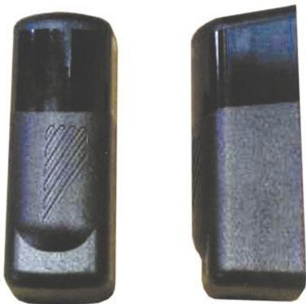
Sistema ad infrarossi con portata di oltre 20 metri formato da un trasmettitore e da un ricevitore particolarmente compatti. Il sistema di regolazione consente un facile allineamento dei due elementi anche in condizioni d'installazione disagiate senza dover ricorrere a staffe, squadrette, ecc. Il led montato sul ricevitore si spegne quando TX e RX risultano perfettamente allineati.
