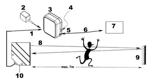
1) Ingresso - 2) Alimentatore di rete - 3) Speaker - 4) Selettore modalità (campanello/allarme/off) - 5) Uscita esterna - 6) Ingresso - 7) Contatore - 8) Fascio della barriera - 9) Retroriflettore - 10) Sensore fotoelettrico
