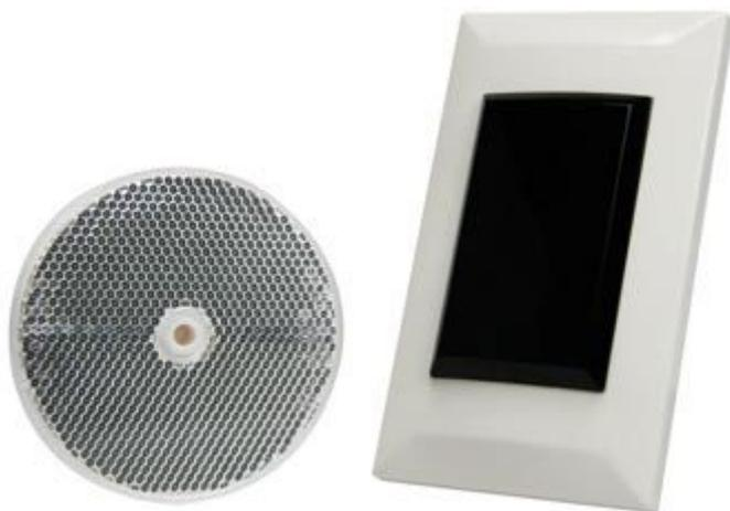
Barriera ad infrarossi a retroriflessione, antinebbia ed antiappannante. Ideale per realizzare barriere di sicurezza, portata massima di circa 7 metri, alimentazione da 12 a 18 Vdc, dimensioni 120 x 70 x 35 mm. Da interno.
