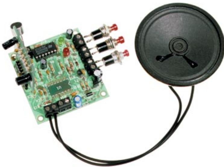
Sistema composto da una scheda base che registra e riproduce messaggi vocali della durata di 12 secondi, e di una scheda miniaturizzata (FT199K venduta separatamente) nella quale vengono trasferiti i messaggi registrati. La scheda base implementa una sintesi vocale realizzata con un chipcorder della ISD in versione a montaggio superficiale. Sono disponibili tre pulsanti: registrazione, riproduzione, attivazione trasferimento messaggio nella scheda miniatura.
