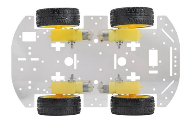
Base robotica costituita da un corpo in materiale acrilico trasparente, quattro motoriduttori, quattro ruote da 65 mm di diametro con pneumatico in gomma morbida con larghezza 26 mm.
