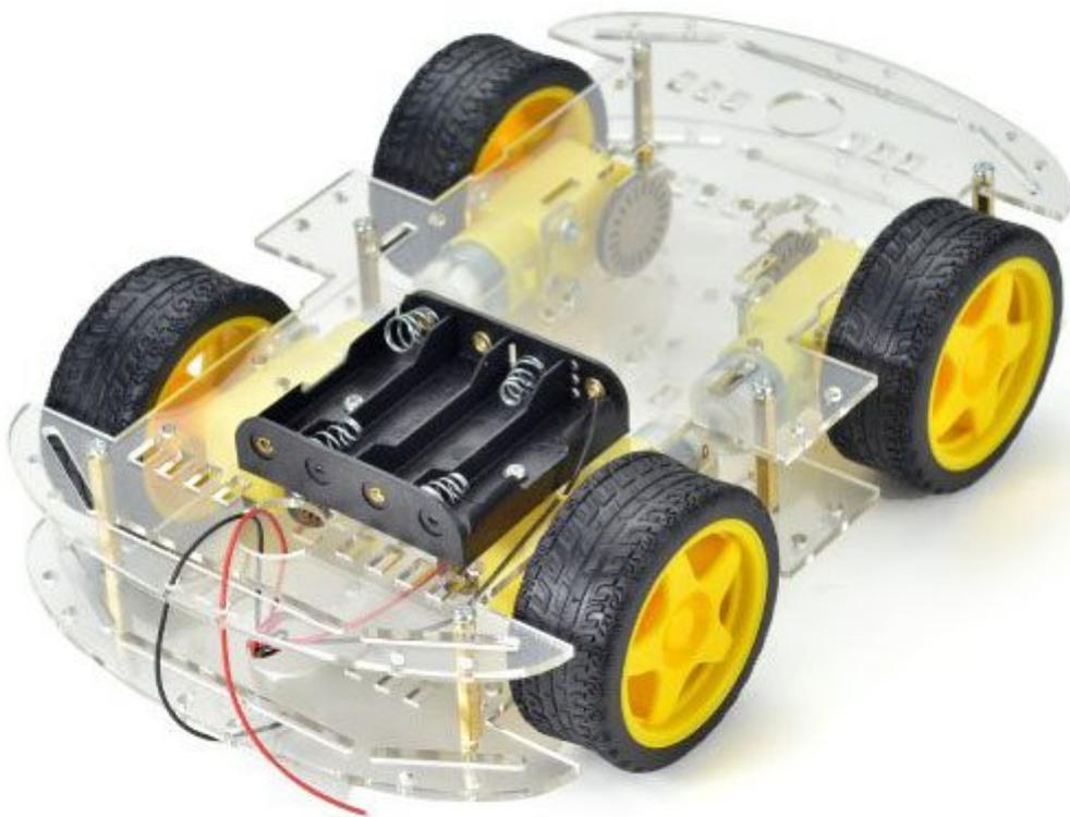
Base robotica costituita da un corpo in materiale acrilico trasparente, quattro motoriduttori, quattro dischi per encoder (senza rilevatore), quattro ruote da 65 mm di diametro con pneumatico in gomma morbida con larghezza 26 mm, portabatteria per 4 batterie stilo da 1,5 V tipo AA, cavetti di collegamento per i motoriduttori, viti, dadi e distanziali.
