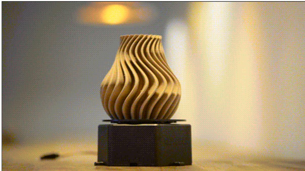
Base rotante realizzata in ABS nero. Un cuscinetto e un servo RC (non compreso) permettono di far girare la parte superiore. La base rotante è in grado di sopportare una forza assiale di circa 49 Newton e laterale di 10 Newton. Dimensioni (mm): 110x58. La confezione comprende tutto il necessario per assemblare la base rotante ad eccezione del servo RC.
