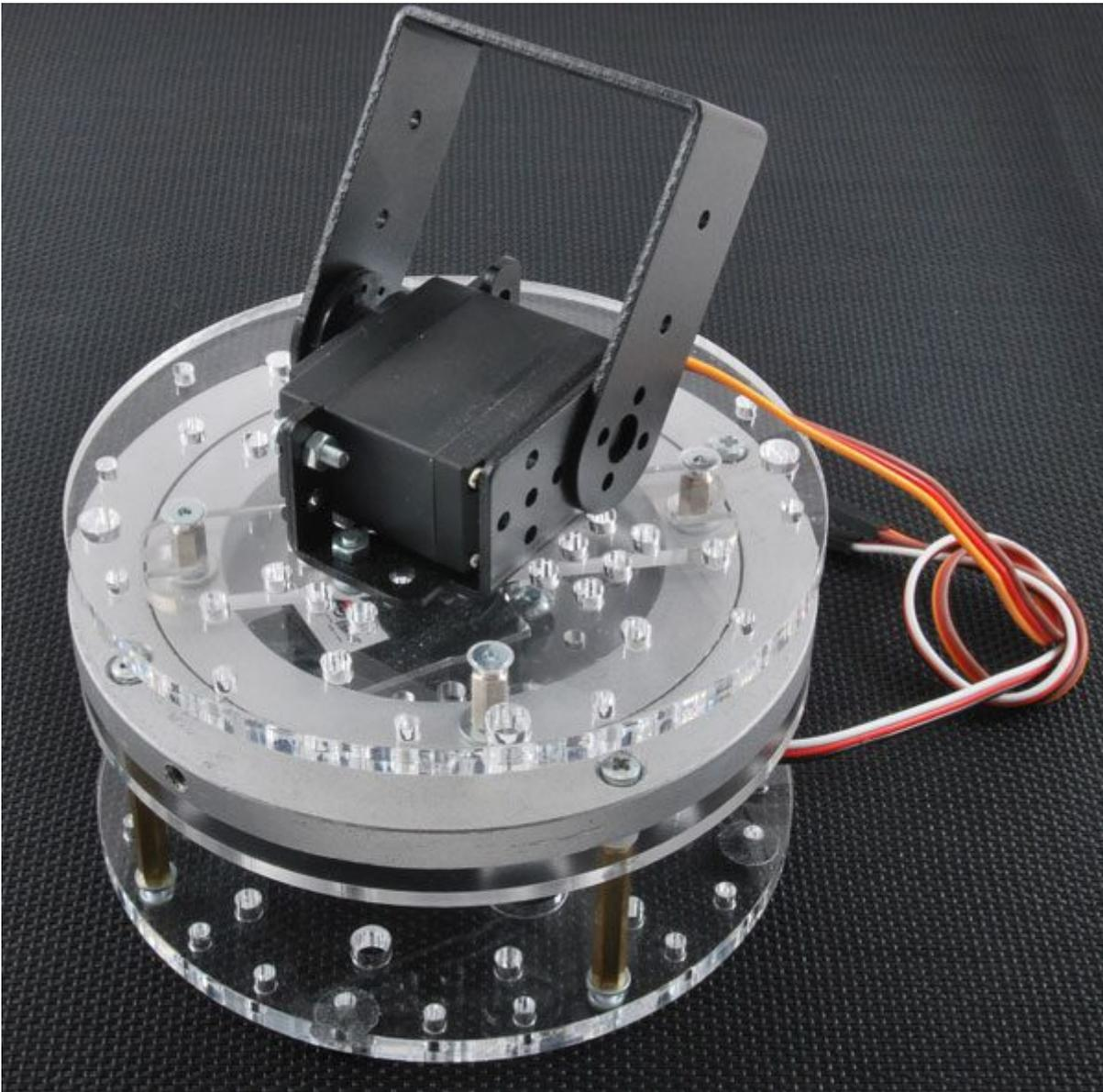
Base rotante in plexiglass realizzata con taglio LASER. È composta da due piastre in plexiglass con diametro 120 mm e 5 mm di spessore, una con diametro 120 mm e 3 mm di spessore, trascinatore in plexyglass per il montaggio di un servo RC, una ralla in lega di alluminio con cuscinetto a una fila di sfere in acciaio (diametro interno: 70 mm – diametro esterno: 120 mm), quattro distanziali esagonali lunghi 40 mm, quattro distanziali esagonali lunghi 10 mm, quattro piedini adesivi, viti e rondelle.
