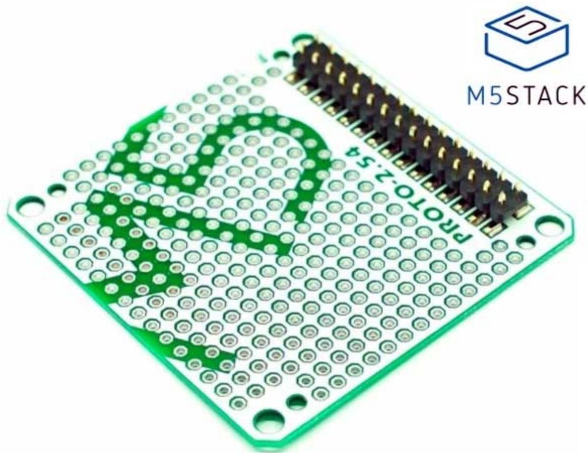
Basetta di prototipazione con 260 piazzole passo 2,54 mm e connettore maschio 2x15 pin (M-BUS) da utilizzare con l'M5STACK. Per utilizzarlo basta semplicemente rimuovere la parte inferiore dell'M5STACK e inserire la basetta.
