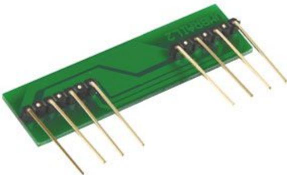
Permette di collegare tra loro alimentazione e Bus dati di 2 moduli Velbus (solo quelli con contenitore compatibile con guide DIN standard a 2 moduli). Dimensione: 55 x 15 mm. La confezione comprende 5 basette.
