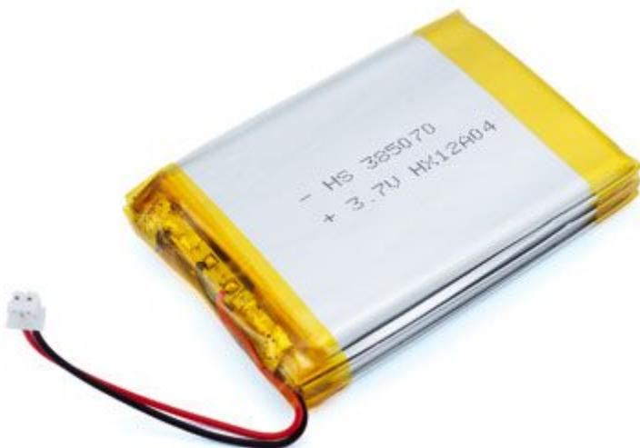
Batteria ricaricabile ai polimeri di litio 3,7 V / 4200 mAh. Connettore: passo pin 2 mm, lunghezza cavo: 5 cm, dimensioni (mm): 72x50x10, peso: 75 grammi.
