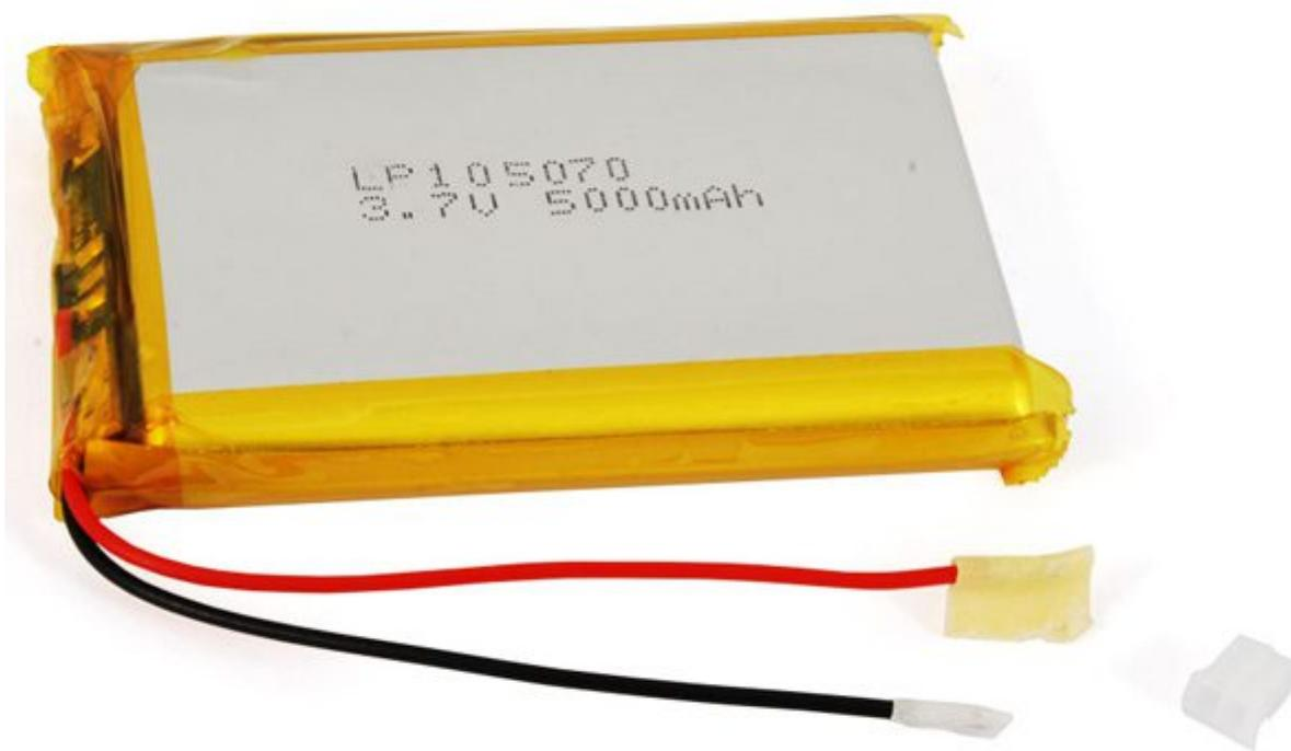
Batteria ricaricabile ai polimeri di litio 3,7 V / 5000 mAh. Connettore: passo pin 2 mm, lunghezza cavo: 5 cm, dimensioni (mm): 71x49x10, peso: 75 grammi. **Attenzione!** per adattare la polarità alle varie applicazioni, la batteria viene fornita con connettore staccato, basta semplicemente inserire i fili nel connettore nella posizione che vi serve per il vostro dispositivo.
