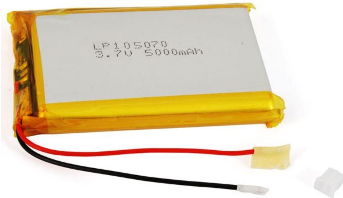
Batteria ricaricabile ai polimeri di litio 3,7 V / 5000 mAh. Connettore: passo pin 2,54 mm, lunghezza cavo: 5 cm, dimensioni (mm): 71x49x10, peso: 75 grammi. **Attenzione!** per adattare la polarità alle varie applicazioni, la batteria viene fornita con connettore staccato, basta semplicemente inserire i fili nel
