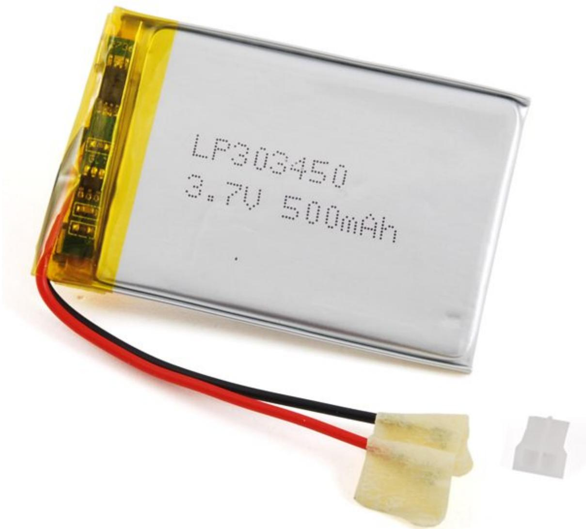
Batteria ricaricabile ai polimeri di litio 3,7 V / 500 mAh. Connettore: passo pin 2,54 mm, lunghezza cavo: 5 cm, dimensioni (mm): 52x34x3, peso: 12 grammi. **Attenzione!** per adattare la polarità alle varie applicazioni, la batteria viene fornita con connettore staccato, basta semplicemente inserire i fili nel connettore nella posizione che vi serve per il vostro dispositivo.
