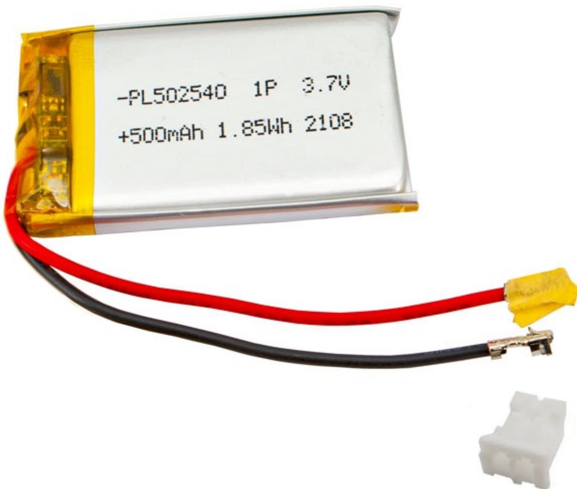
Batteria ricaricabile ai polimeri di litio 3,7 V / 500 mAh. Connettore: passo pin 2,54 mm, lunghezza cavo: 5 cm, dimensioni (mm): 43x24,5x4,9, peso: 10 grammi. **Attenzione!** per adattare la polarità alle varie applicazioni, la batteria viene fornita con connettore staccato, basta semplicemente
