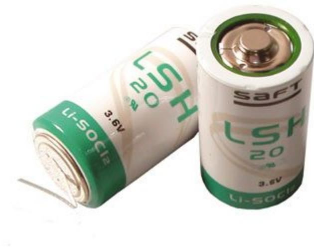
Batteria al litio in formato "D" con terminali a saldare con capacità di 13000 mAh/3,6V. Ideale per applicazione telecom in virtù della elevatissima corrente di spunto (4A), della notevole corrente continua che è in grado di erogare (1,8A) e della particolare curva di scarica.
