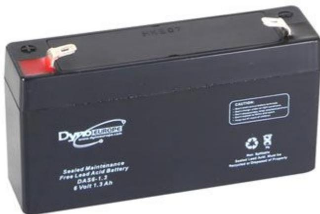
Batteria ricaricabile sigillata con tensione nominale di 6 V, capacità di 1,3 Ah e basso livello di aut scarica. Dimensioni: 98 x 25 x 56 mm; peso: 320 g. Adatta per sistemi di allarme, UPS, giocattoli, ecc.
