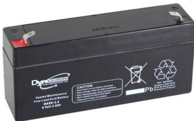
Batteria ricaricabile sigillata con tensione nominale di 6 V, capacità di 3,2 Ah e basso livello di autoscarica. Dimensioni: 134 x 34 x 66 mm; peso: 730 g. Adatta per sistemi di allarme, UPS, giocattoli, ecc.
