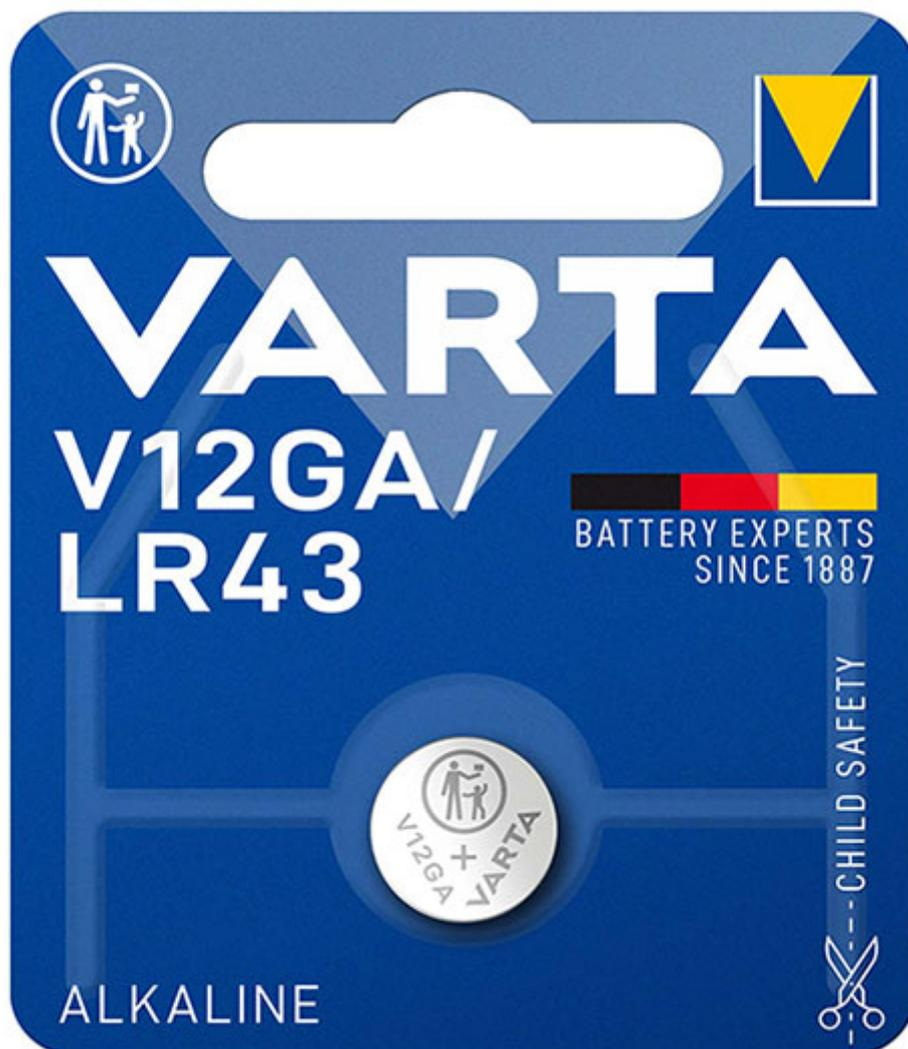
Batteria alcalina a bottone Varta V12GA / LR43 in grado di fornire una tensione di 1,5 volt. Ha un diametro di 11,6 mm e un'altezza di 4,2mm. Questo tipo di batteria è comunemente utilizzato in dispositivi elettronici come orologi, calcolatrici, giocattoli, telecomandi e altri piccoli dispositivi portatili. Grazie alla sua tecnologia alcalina, offre una lunga durata e una buona affidabilità nelle applicazioni a basso consumo energetico.
