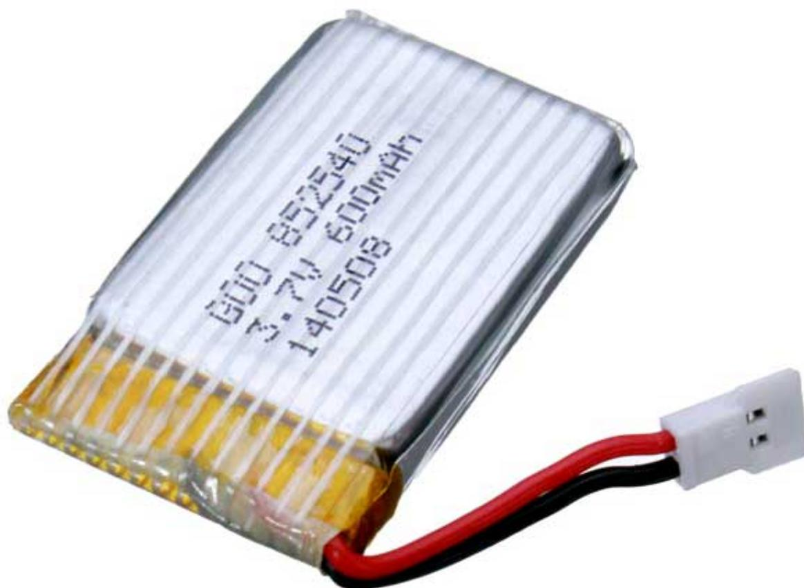
Batteria ricaricabile ai polimeri di litio da 3,7 V / 600 mAh per mini quadricottero QX90. Tempo di carica: circa 30 minuti, lunghezza cavo: 35 mm, dimensioni (mm): 40x25x8,5, peso: 17,3 grammi.
