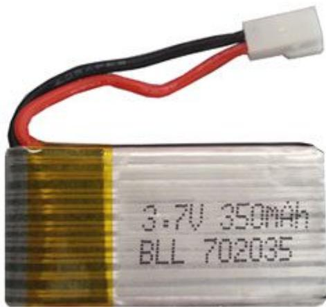
Batteria ricaricabile ai polimeri di litio 3,7 V / 350 mAh per quadricottero 310B. Lunghezza cavo: 3,5 cm, dimensioni (mm): 39x20x7, peso: 10 grammi.
