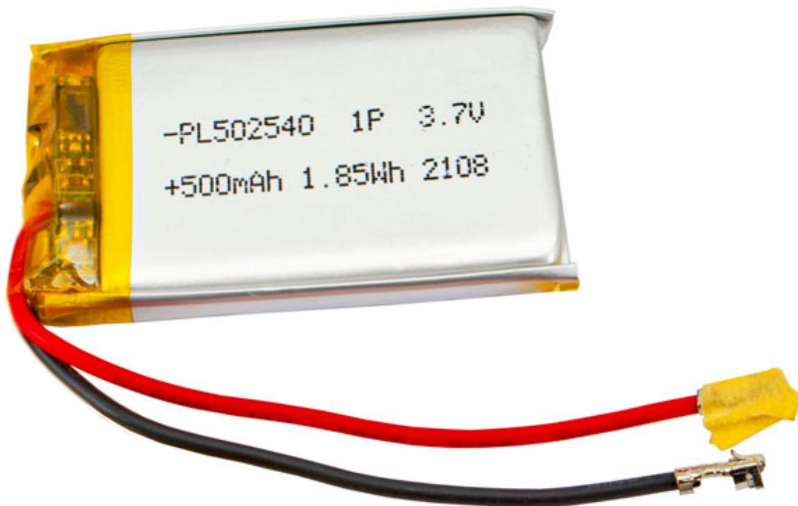
Batteria ricaricabile ai polimeri di litio 3,7 V / 500 mAh. Connettore JST 2 fili: rosso per il positivo, nero per il negativo. Non dispone di controllo della temperatura. Passo pin 2,54 mm, lunghezza cavo: 5 cm, dimensioni (mm): 43x24,5x4,9; peso: 10 grammi.
