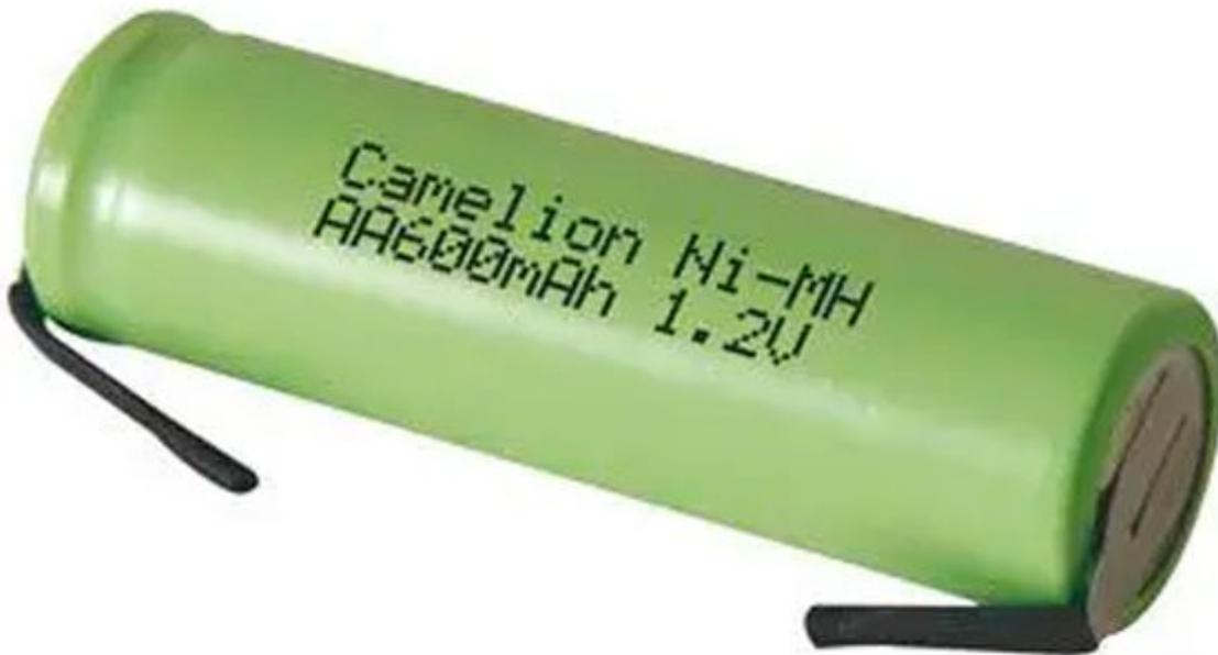
Batteria ricaricabile al Ni-MH da 1,2 V / 600 mAh. Dispone di connettori a saldare. Dimensioni: Ø14,2 x 49,3 mm.
