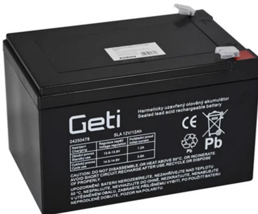
Batteria ricaricabile [AGM](#) a bassissima autoscarica con tensione nominale 12 volt e capacità 12 Ah. È una batteria esente da manutenzione, sigillata ermeticamente e adatta per essere impiegata in un ampio campo di applicazioni: solare, antifurti, backup, UPS, illuminazione d'emergenza, ecc. La modalità di ricarica consigliata è quella a corrente costante.
