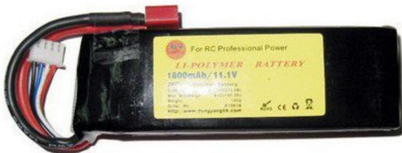
Batteria ricaricabile **LiPo** (litio-polimero) con tensione nominale di 11,1 V e capacità di 1800 mAh-20C. Continuous Discharge: 20C (36 A), Max Discharge: 40C (72 A), Balance charge connector: US Standard Connector. Dimensioni: 104x35x23 mm, peso: 152 g. **N.B.** la batteria deve essere caricata solo ed esclusivamente con i caricabatteria specifici per LiPo.
