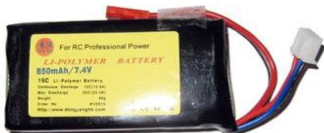
Batteria ricaricabile **LiPo** (litio-polimero) con tensione nominale di 7,4 V e capacità di 850 mAh-15C. Continuous Discharge: 15C (12,8 A), Max Discharge: 30C (25,5 A), Balance charge connector: US Standard Connector. Dimensioni: 53x31x15 mm, peso: 48 g. **N.B.** la batteria deve essere caricata solo ed esclusivamente con i caricabatteria specifici per LiPo.
