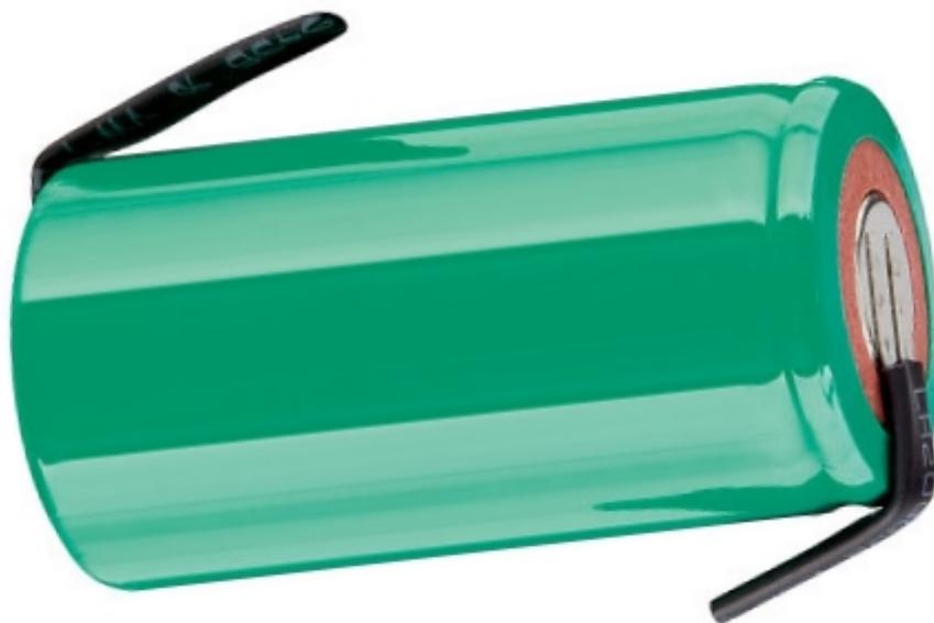
Batteria ricaricabile al Ni-MH formato Sub-C con contatti a saldare. Voltaggio: 1,2 V, massima capacità: 1.500 mAh, materiale della guaina esterna: PVC, temperatura di lavoro: da -20°C a +50°C, dimensioni (mm): 43 (altezza) x 23 (diametro).
