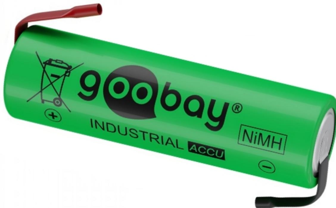
Batteria ricaricabile **ready-to-use** a bassa autoscarica. Ni-MH da 1,2 V / 2100 mAh tipo AA. Dispone di connettori a saldare. Dimensioni: Ø14,2 x 49,5 mm. Le batterie Goobay "ready-to-use" NiMH sono precaricate e possono essere subito utilizzate. Oltre alla minima autoscarica sono ecologiche dato che si
