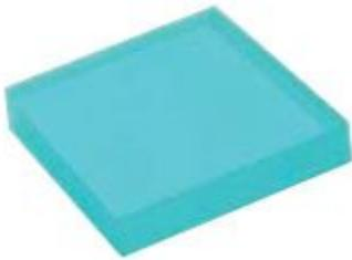
Dispositivo ottico, costituito da lastra di vetro ottico con deposizione di film sottile di alluminio, in grado di dividere un fascio laser in due. Dimensioni 1,2 x 20 x 20mm.
