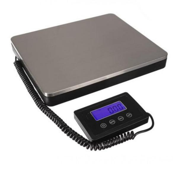
Bilancia elettronica pesapacchi (max. 100 kg) con cella di carico ad alta precisione. Dispone di una base di pesatura in acciaio inossidabile alla quale è collegato, tramite un cavo, il display LCD con retroilluminazione blu che visualizza la misura e dove può essere selezionata l'unità di misura (chilogrammo, grammo, libbra, oncia), superamento portata, funzione calibrazione. Alimentazione: 2 batterie da 1,5 V tipo AAA (incluse).
