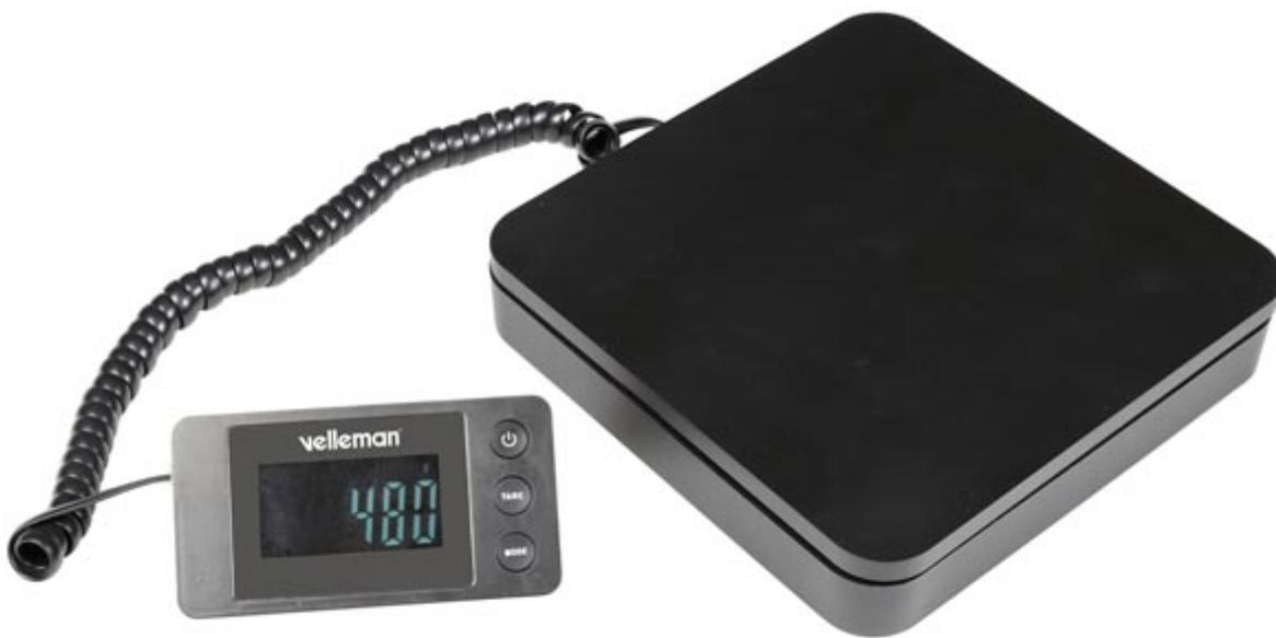
Bilancia elettronica pesapacchi (max. 40 kg) con cella di carico ad alta precisione. Dispone di una base di pesatura alla quale è collegato, tramite un cavo, il display LCD retroilluminato che visualizza la misura e dove può essere selezionata l'unità di misura (chilogrammo, grammo, libbra, oncia), superamento portata, funzione calibrazione. Alimentazione: 2 batterie da 1,5 V tipo AAA (incluse).
