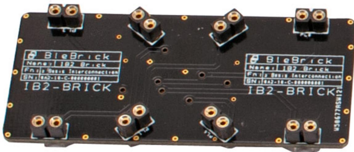
Il Blebrick IB2 è una base di montaggio a due posizioni che consente il collegamento di più Blebricks su una piattaforma orizzontale. Dimensioni (mm): 22,5x51x5, temperatura di lavoro: da -40°C a +85°C.
