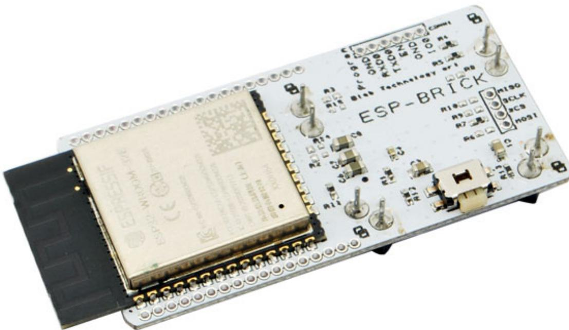
Il **Blebrick ESP** è un mattoncino di comunicazione ed elaborazione dati che integra un modulo ESP32. Può essere utilizzato per offrire le seguenti funzionalità aggiuntive:
