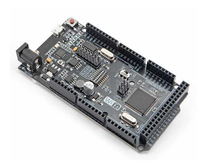
**FISHMEGAWIFI** è la soluzione ideale per i tuoi progetti che richiedono potenza, versatilità e connettività Wi-Fi. Questa scheda combina il microcontrollore ATmega2560 e il modulo Wi-Fi SoC (**System-On-a-Chip**) ESP8266, offrendo una vasta gamma di funzionalità che la rendono indispensabile per gli appassionati di elettronica e gli esperti del settore.
