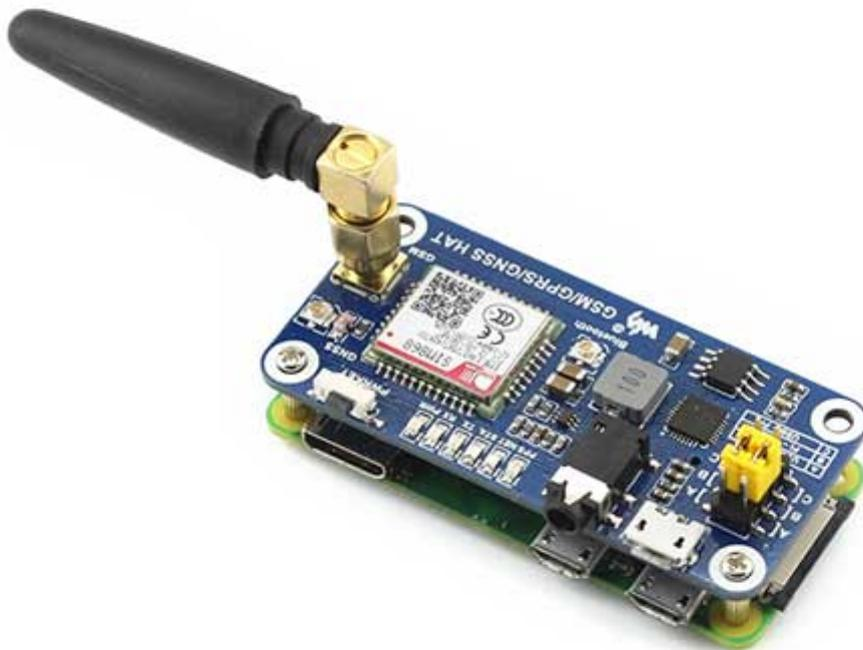
Board GSM/GPRS/GNSS per Raspberry Pi basata sul modulo SIM868. Compatibile con Raspberry Pi 2B/3B/3B+/Zero/Zero W, supporta l'invio di SMS, chiamate vocali, GPRS, DTMF, HTTP, FTP, MMS, email con possibilità di trasferire i dati tramite Bluetooth. Rilevamento automatico Baudrate, indicazione stato di funzionamento della board tramite 6 LED, controllabile tramite comandi AT. Disponibili per il download manuale e di risorse per lo sviluppatore. **La scheda Raspberry Pi non è inclusa.**
