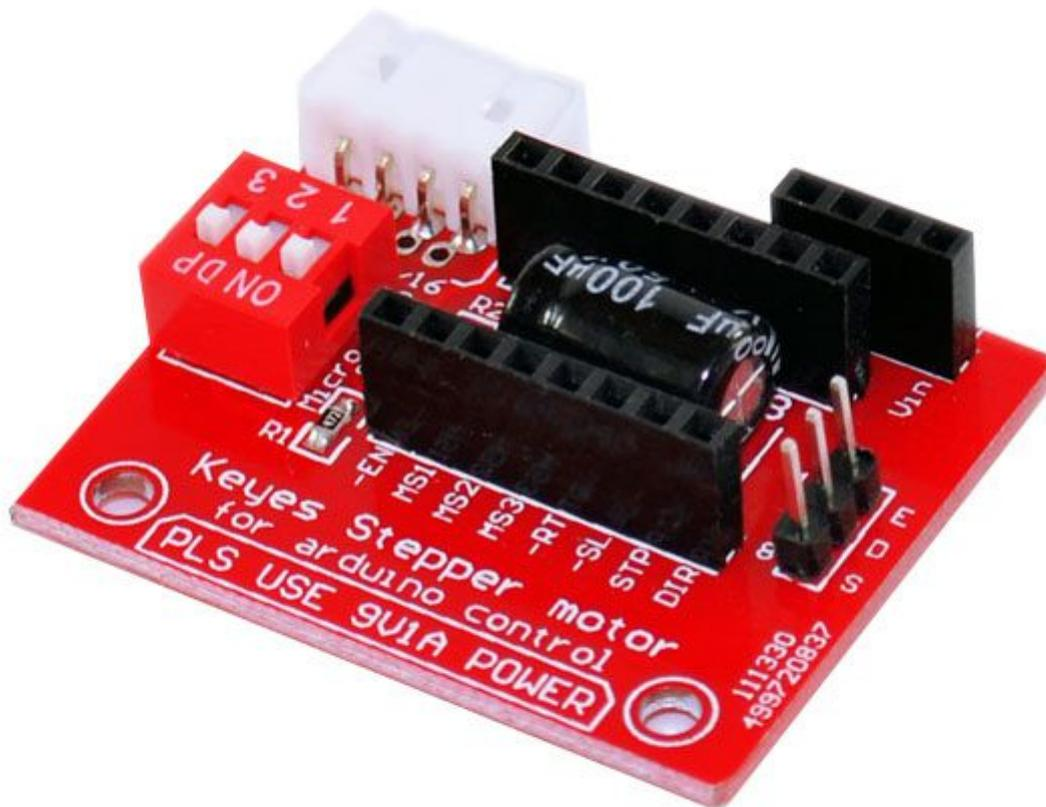
Questa piccola scheda è stata realizzata appositamente per semplificare l'utilizzo dei moduli driver per motori passo-passo tipo A4988, DRV8825, 3DDRIVER o altri con piedinatura identica. Dispone di zoccolo per l'inserimento del driver per motori passo-passo, dip-switch per l'impostazione del numero di step (passo, 1/2, 1/4, 1/8 e 1/16), connettore con pin di controllo (E= Enable, S= Step, D= Dir) e alimentazione. Dimensioni (mm): 34,5x42x11, peso: 9 grammi.
