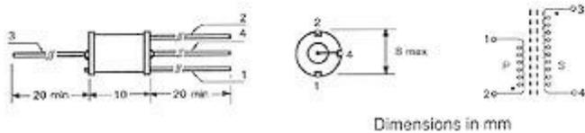
Bobina di trigger strobo. Tensione d'uscita: 4kV, alimentazione: 300V, capacità trigger 0,1 $\mu$ F, energia 2mJ.
