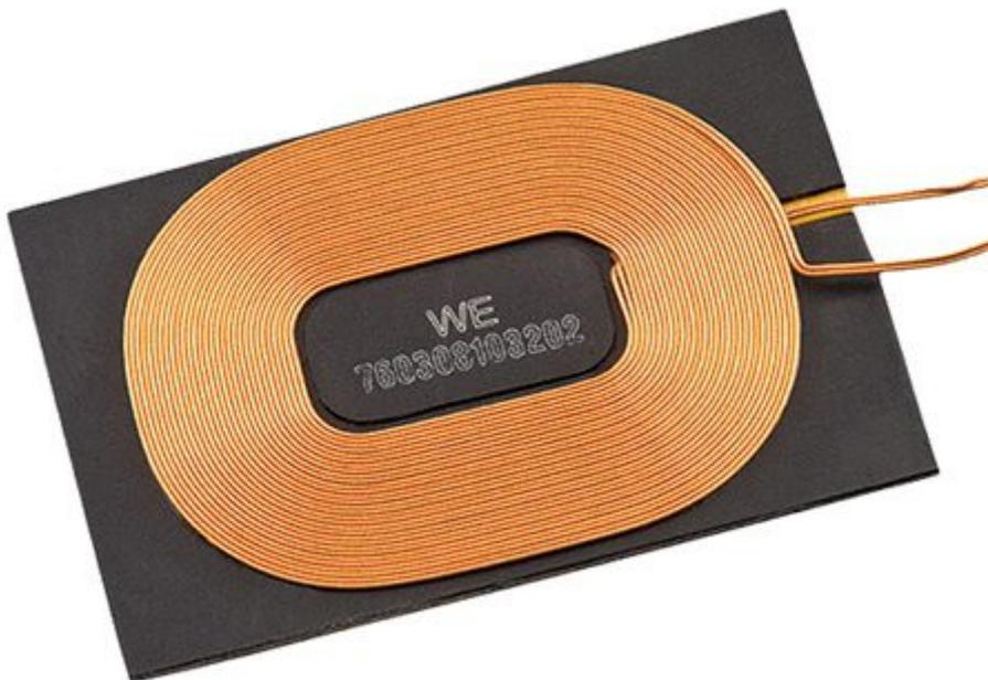
Bobina della Wurth Elektronik, induttanza 12  $\mu$ H, indicata per la ricarica wireless WE-WPCC serie Qi. L'abbinamento con un'induttanza trasmittente permette di creare un sistema di carica wireless, sfruttando l'innovativa tecnologia Wurth per ricaricare dispositivi elettronici come telefoni cellulari, tablet smart watch ecc.
