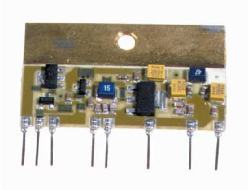
Circuito lineare in Classe A per segnali CATV, operante sul canale UHF 22, in grado di amplificare un segnale con informazioni audio-video di alta qualità. Ingresso del segnale RF compatibile con i Modulatori Audio Video ed è particolarmente adatto ad amplificare il segnale prodotto dai modelli TXAV/UHF. Potenza R.F: 20 mW con 1 mW in ingresso per il canale UHF 22, alimentazione: 12 V, consumo: 100 mA.
