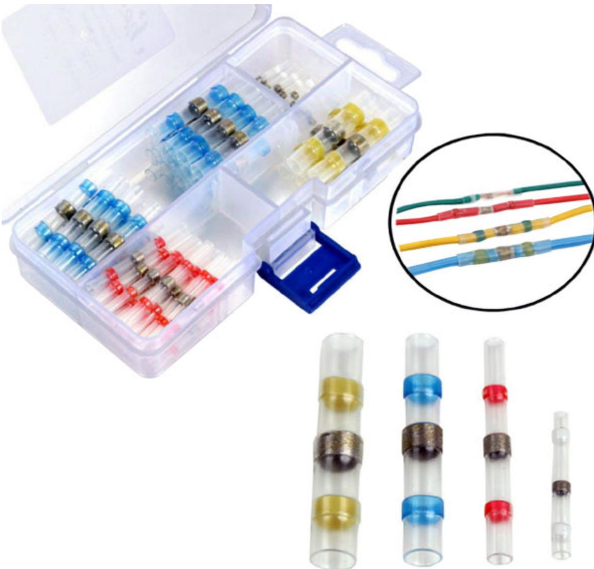
Box plastico trasparente contenente 50 guaine termorestringenti con all'interno un anello di stagno e due anelli di adesivo. Rapporto di restringimento: 2:1, temperatura di lavoro: da -55°C a +105°C, temperatura completo scioglimento stagno: 115°C. Permette di effettuare il collegamento elettrico (saldatura) di due conduttori mediante trattamento termico (tramite riscaldatore industriale), fornendo la tenuta dei due conduttori e rendendo impermeabile la saldatura. La confezione comprende:
