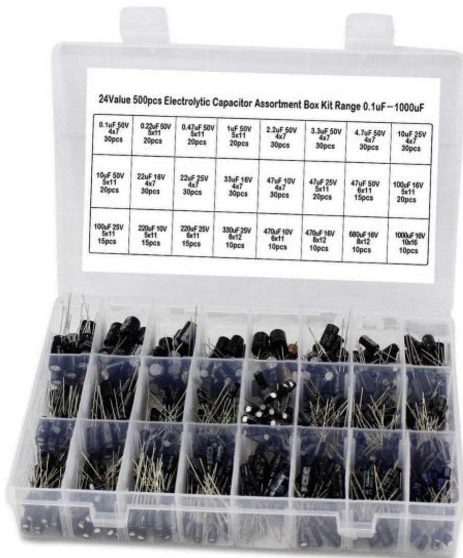
Box plastico trasparente con scomparti e cerniera di chiusura contenente 500 condensatori elettrolitici radiali suddivisi in 24 valori compresi da 0,1 $\mu$ F – 1000 $\mu$ F. Dielettrico: alluminio.
