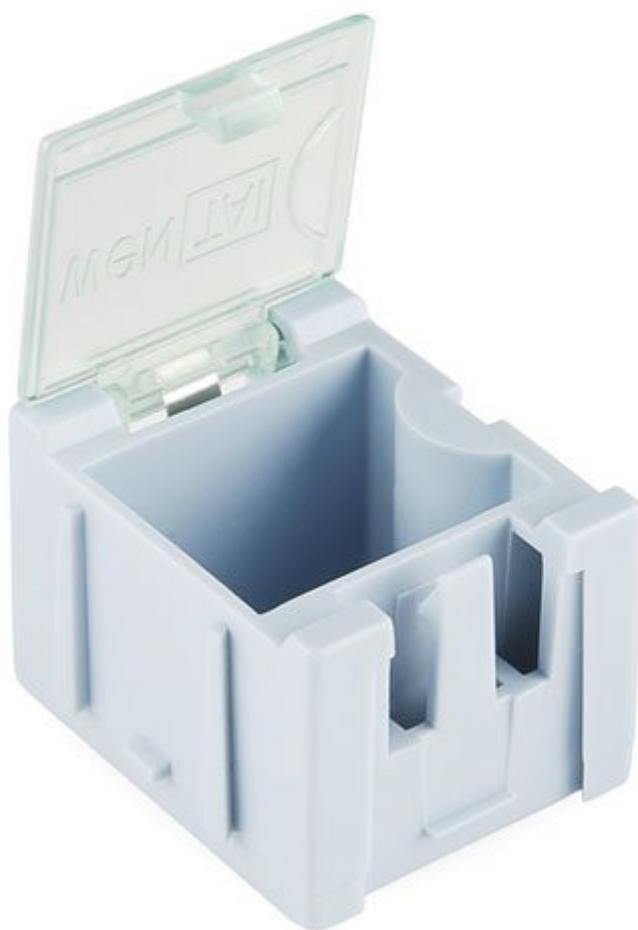
Mini contenitore plastico modulare, con coperchio semitrasparente e apertura a scatto. Ideale per componenti miniatura o SMD. Dimensioni esterne singolo contenitore (mm): 25 x 30 x 22, dimensioni interne singolo contenitore (mm) 18 x 17,5 x 18. Attenzione! il colore può variare a seconda della disponibilità in magazzino.
