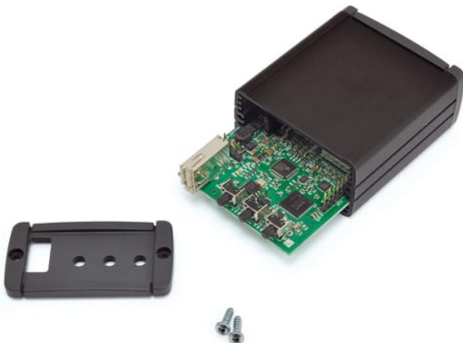
Contenitore in alluminio estruso con verniciatura esterna di elevato standard qualitativo e due pannellini in ABS appositamente forati per ospitare il prodotto FT1185M (FILO DIFFUSIONE AUDIO SU RETE ETHERNET). Dimensioni esterne (mm): 70 (lunghezza) x 59,9 (larghezza) x 30,9 (altezza). **N.B.** il prodotto FT1185M non è compreso (vedere prodotti correlati).
