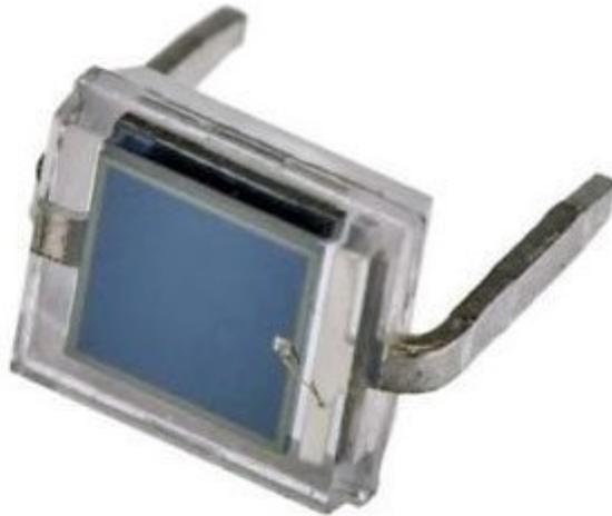
BPW34 della Vishay Semiconductor, è composto da fotodiodi PIN al silicio. Sono in un contenitore rettangolare con una parte superiore piatta. Sensibile alla radiazione nel visibile e nel vicino IR. Sono adatti per applicazioni di fotorilevazione ad alta velocità.
