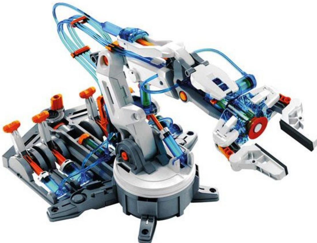
Kit di montaggio di braccio robotico idraulico a 6 assi. Grazie alle [istruzioni dettagliate](#) e ricche di illustrazioni grafiche, l'assemblaggio delle 229 parti di montaggio che lo compongono, risulterà estremamente facile e divertente. Nessun motore e nessuna batteria! Il movimento sui sei assi viene azionato tramite il sistema idraulico ad acqua, agendo sui controller a leva. Massima capacità di sollevamento: 50 g.
