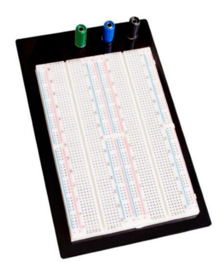
Breadboard in ABS con 1660 contatti, boccole per le linee di alimentazione e piedini in gomma, il tutto montato su una robusta piastra in metallo con tre fori per l'installazione delle boccole. Dimensioni breadboard (mm): 164x109x9,5; dimensioni piastra in metallo (mm): 215x131x1; peso: circa 350 grammi.
