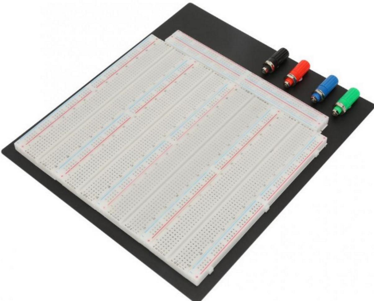
Breadboard in ABS con 3220 contatti, boccole per le linee di alimentazione e piedini in gomma, il tutto montato su una robusta piastra in metallo con tre fori per l'installazione delle boccole. Dimensioni breadboard (mm): 188x182x9,5; dimensioni piastra in metallo (mm): 240x210x1; peso: circa 670 grammi. Ideale per esperimenti di circuiti elettronici senza saldatura. Basta semplicemente inserire i componenti sulla breadboard, collegarli con alcuni jumper !
