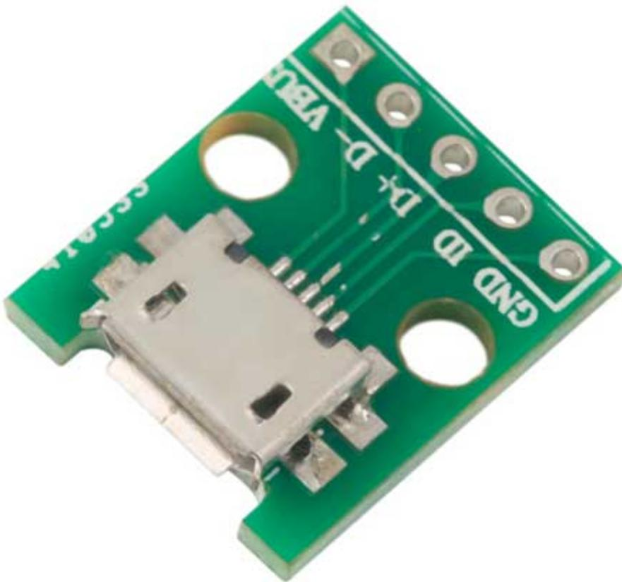
Breakout board con connettore micro USB femmina a 5 pin (VBUS, D-, D+, IO, GND) disponibili tramite piazzole. Dimensioni (mm): 20x18,2x5,6. Ideale per prototipazione.
